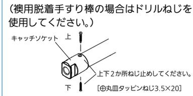
**5** 左側の受側ブラケットを取付けます。もう一方のキャッチソケットを手すり棒に差込み、両端を受側ブラケットにセットして手すり棒が水平になる位置で、先に受側ブラケットをねじ止めます。 ※両側の受側ブラケットの上下位置を合わせ、ねじれ位置にならない様にしてください。
