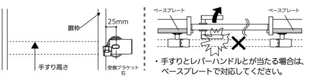
**3** ブラケットピッチを決めて手すり棒をカットします。手すり棒長さ=ブラケットピッチから、-82mmカットします。
