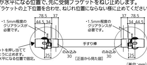
※受側ブラケットを押し当ててガタの無いように止めます。 ※手すり棒が水平になる位置で固定。
